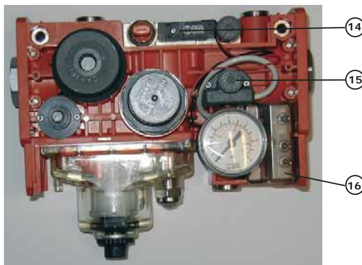
Figur C – Identifiering av inbyggda komponenter
